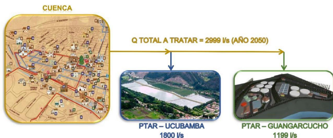
Figura 4-1: Caudales a Tratar en Ucubamba y Guangarcucho
