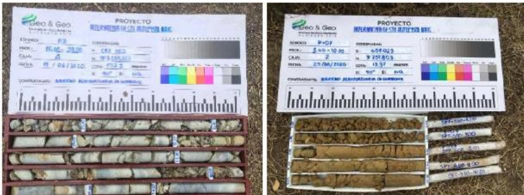
Los sondeos se ejecutarán de tal modo que permitan conseguir una satisfactoria recuperación de un testigo continuo en el sustrato de suelo o roca, además se realizará, la identificación litológica, medida RQD y descripción detallada de su fisuración y diaclasado (ángulo y orientación, separación, carácter, consistencia).
