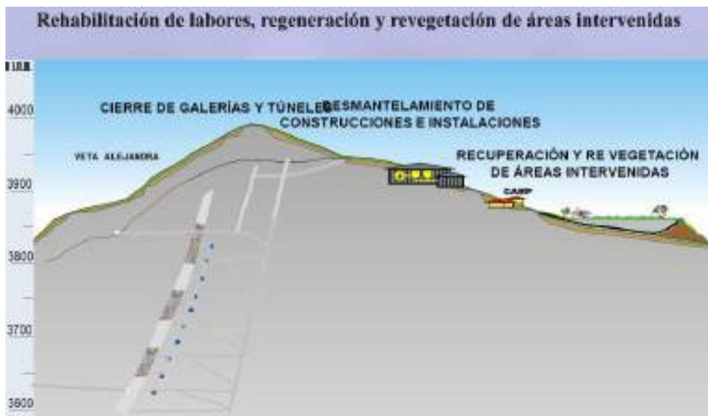
Figura 16: Plan de rehabilitación (Fuente:IMC)
