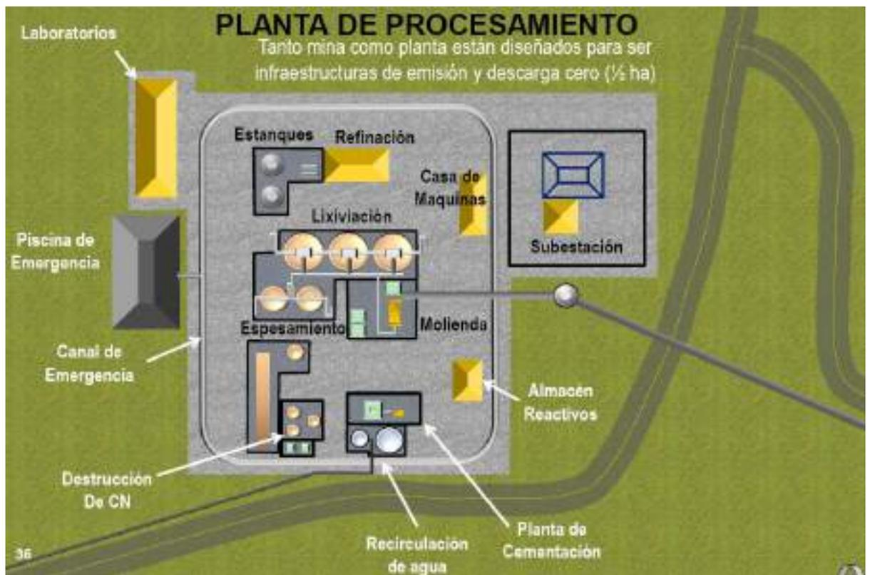
Figura 11: Planta de procesamiento (Fuente: IMC)
